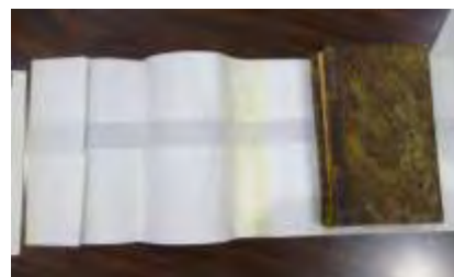
写真 3 中性紙製ジャケット (中央部が変色している)
